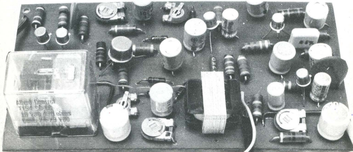
La semplicità costruttiva ed il funzionamento sicuro sono le caratteristiche più interessanti del VOX-CB. Un'immagine del prototipo approntato in laboratorio.
